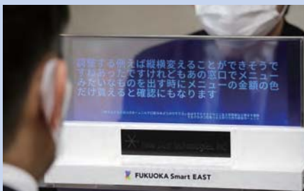
相手の言葉を文字化する「字幕透明ディスプレイ」 (開発：ピクシーダストテクノロジーズ株式会社)
